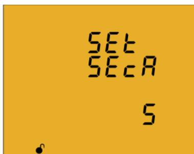
En esta pantalla se selecciona el secundario del transformador de corriente.
