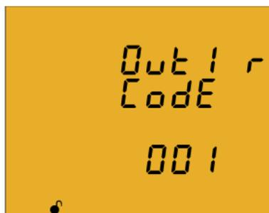
En esta pantalla se selecciona el código de la variable, en función de la **Tabla 15**, que controlará el relé de alarma 1.
