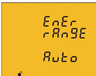
En esta pantalla se selecciona el funcionamiento del rango de energía.
