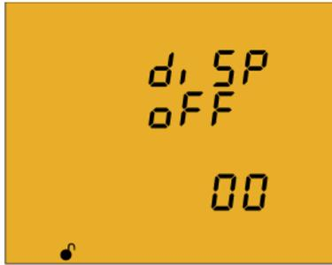
En esta pantalla se programa el tiempo que el Backlight permanecerá encendido (en segundos) desde la última manipulación del equipo mediante el teclado.
