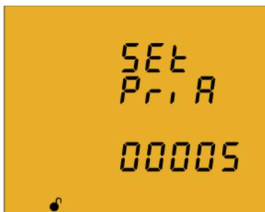
En esta pantalla se programa el primario del transformador de corriente.
