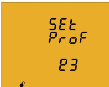
En esta pantalla se selecciona el perfil de funcionamiento del equipo. Para poder editar la selección del perfil de funcionamiento pulsar la tecla
