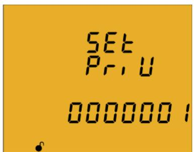
En esta pantalla se programa el primario del transformador de tensión. Para poder editar el valor del primario del transformador pulsar la tecla
