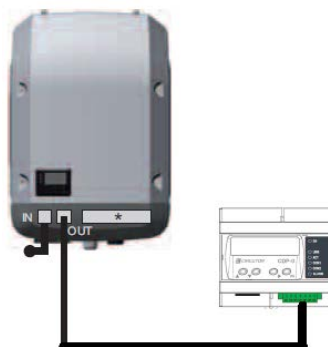
Figura 9: Conexión entre un CDP y un único inversor Fronius ECO.
