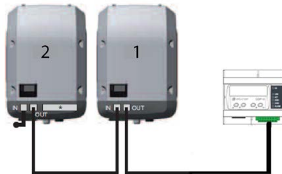
Figura 2: Conexión entre un CDP y varios inversor Fronius Galvo.
