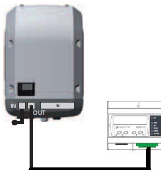
Figura 1: Conexión entre un CDP y un único inversor Fronius Galvo.
