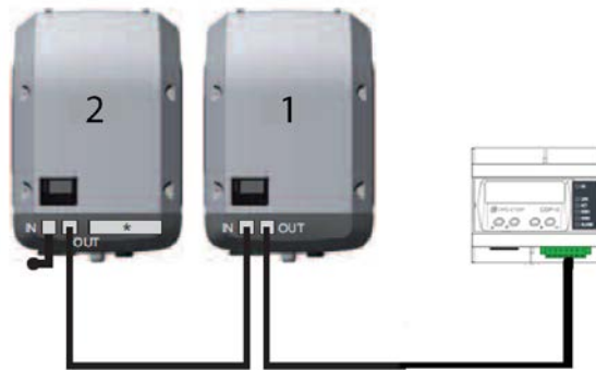
Figura 13: Conexión entre un CDP y varios inversor Fronius PRIMO.
