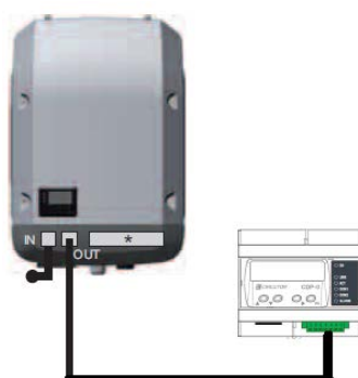
Figura 12: Conexión entre un CDP y un único inversor Fronius PRIMO.
