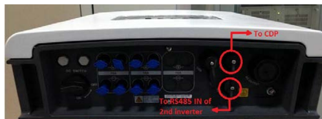
Figura 2: Conexión entre un CDP y varios inversor.
