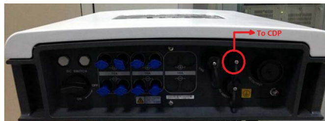
Figura 1: Conexión entre un CDP y un único inversor.
