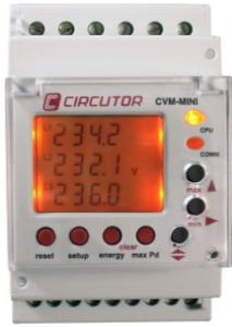
Le CVM-MINI-MC est un instrument qui mesure, calcule et affiche les principaux paramètres électriques sur les réseaux industriels triphasés (équilibrés ou déséquilibrés). La mesure est réalisée en véritable valeur efficace, moyennant trois entrées de tension c.a. et trois entrées d'intensité c.a. (à travers les transformateurs de courant  $I_n$  / 250 mA). Les paramètres mesurés et calculés sont montrés sur le tableau des variables.
