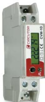
Der Analysator Typ CVM-1D ist ein Messinstrument zum Messen, Kalkulieren und Anzeigen der Hauptparameter von industriellen und häuslichen Einphasennetzen. Das Messen erfolgt als RMS-Wert durch Direktmessung von Strom und Spannung. Die gemessenen und berechneten Parameter sind in der Tabelle der Variablen dargestellt.
