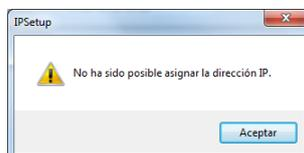
Revise la configuración asignada al equipo, verifique la conexión al router y que los LED del conector Ethernet se encienden y/o parpadean. El LED del lado izquierdo del conector es el LINK STATUS y el LED del lado derecho indica actividad de recepción / emisión TX/RX. Ambos pueden estaren color verde o ambar. Si aparentemente todo es correcto, consulte al administrador de su red de área local.
