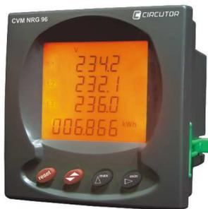
El **CVM NRG 96** es un instrumento que mide, calcula y visualiza los principales parámetros eléctricos en redes industriales trifásicas (equilibradas o desequilibradas). La medida se realiza en verdadero valor eficaz, mediante tres entradas de tensión c.a. y tres entradas de intensidad c.a. (a través de transformadores de corriente In .15A ./1A). Los parámetros medidos se muestran en la tabla de lista de variables.
